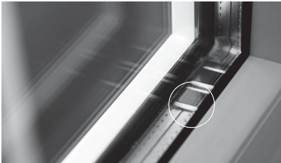
Der im Fensterrahmen angebrachte Chip versorgt sich selbst mit Energie. (© Fraunhofer IMS) | Bild in Farbe und Druckqualität: www.fraunhofer.de/presse
