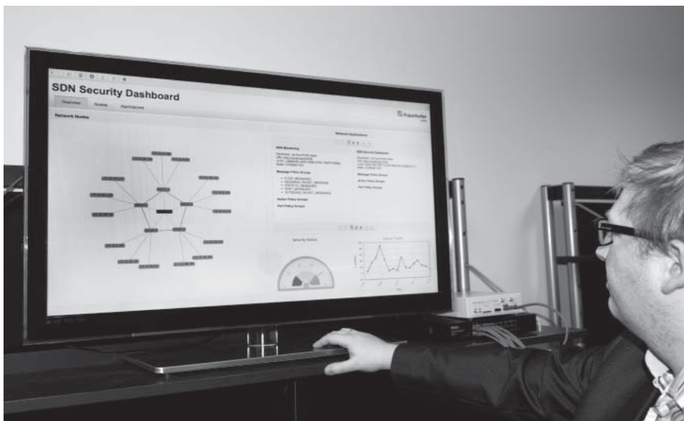
Mit ihrer Visualisierungs-Software können die Forscher vom AISEC alle Komponenten eines Software Defined Network überwachen. (© Fraunhofer AISEC) | Bild in Farbe und Druckqualität: www.fraunhofer.de/presse
